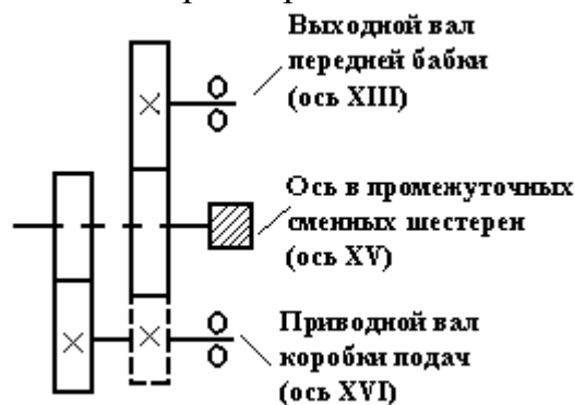
Рисунок 16 - Схема установки сменных шестерен
